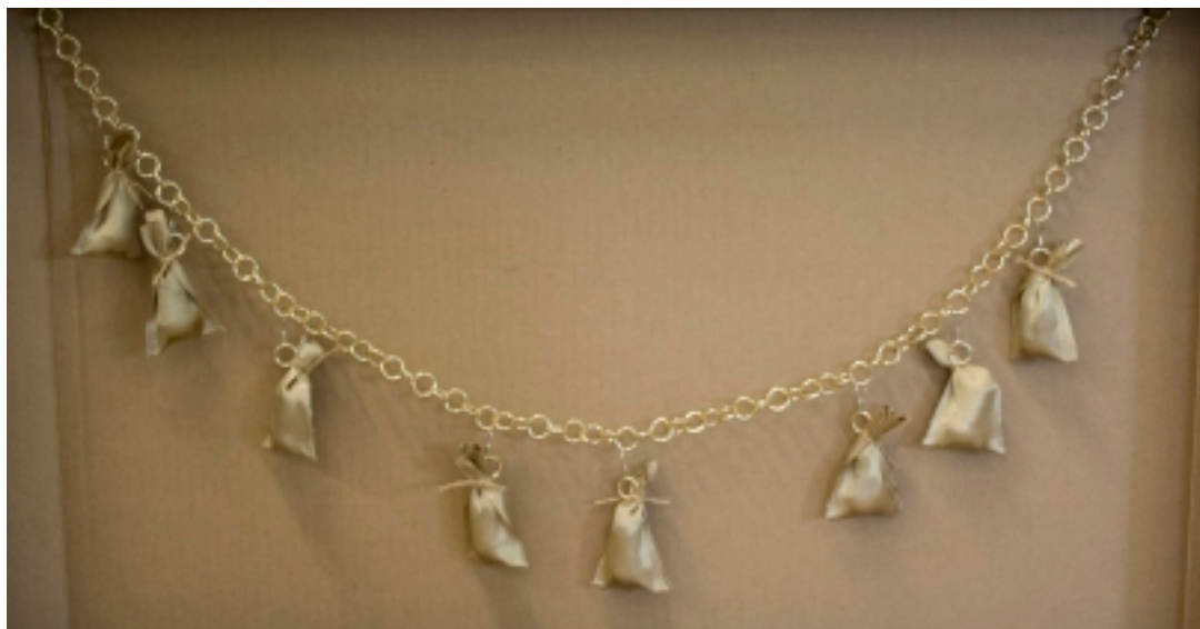
rappresentazione di una catenaria con la Distribuzione dei pesi.
